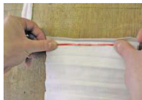
Am Oberteil Draht in die Kantenverstärkung einlegen.
